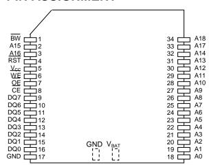
34-Pin PowerCap Module (PCM) (Uses DS9034PC+ or DS9034PCI+ PowerCap)
